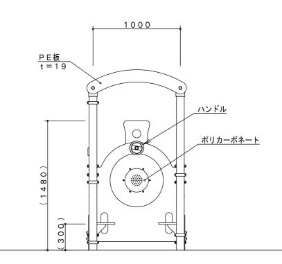
鋼材は、電気亜鉛メッキ処理後、合成樹脂焼付塗装とする(基礎部品は除く)。 ボルト・ナットは、電気亜鉛メッキ処理とする。
