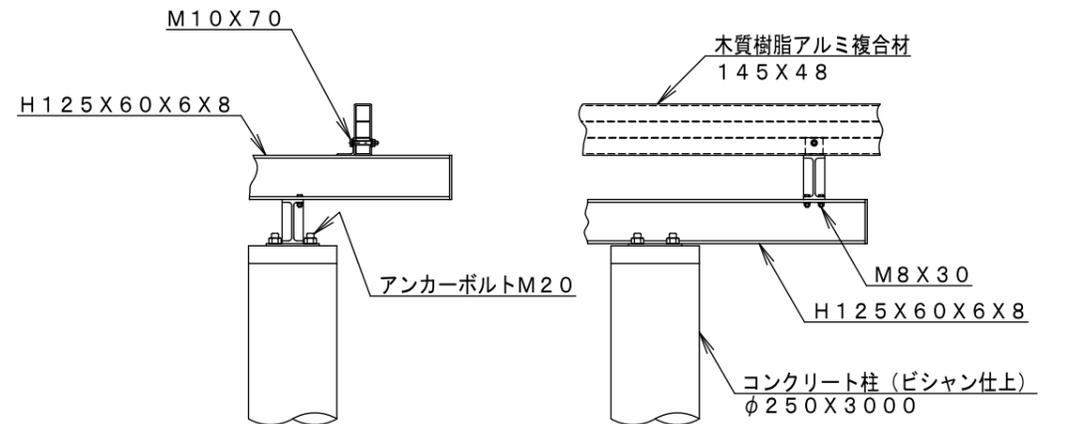
柱先端部詳細図 S=1/20
